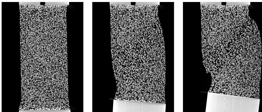
FIGURE 1 – Coupes transversales d'images 3D par tomographie à rayon X (CT) à différents moments d'une séquence d'un échantillon cylindrique déformé, acquises lors d'un test de compression triaxiale qui induit une bande de cisaillement.
